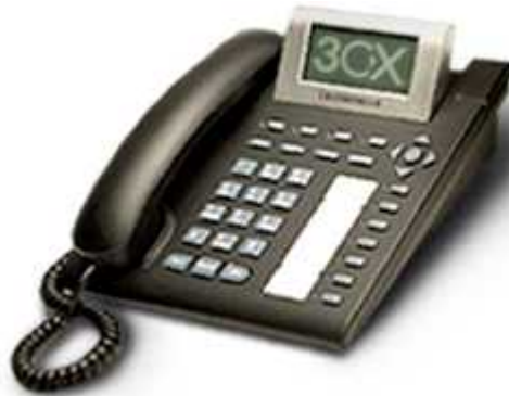
Abbildung 2 – Telefon-Hardware mit SIP-Unterstützung
